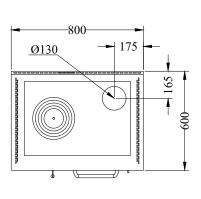
Versione con uscita fumi a destra. La versione con uscita fumi a sinistra è simmetrica.
